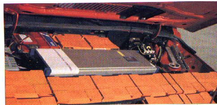
Το σύστημα συσσωρευτών και ο ενσωματωμένος φορτιστής των
